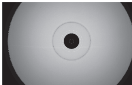
图 12 镜头杂散光系数测试图 Fig. 12 Lens stray light coefficient test diagram
