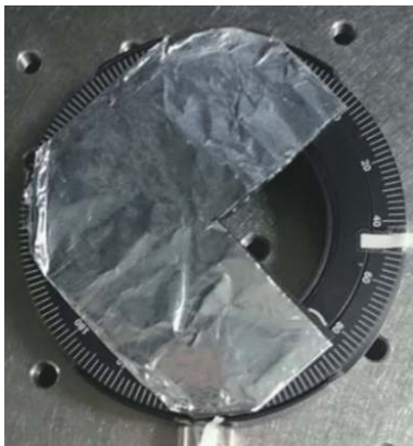
图 2 四分之三象限太赫兹波挡板示意图 Fig. 2 Three-quarter quadrant THz wave baffle.
