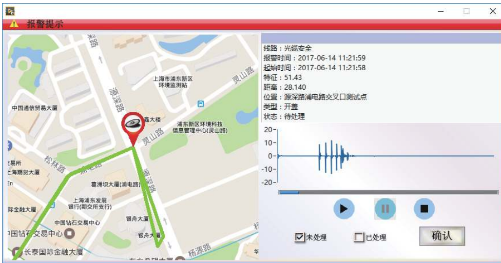
图 4 电缆沟线路安全监控系统报警界面
